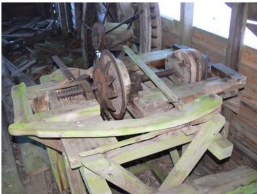
Reimdriven dreiebenk for tønne lok. I bakgrunnen gammalt turbinhjul.
