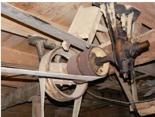
Reimene overførte krafta frå vass turbinen.
