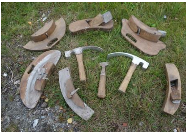
Norvald Reistad sine handverktøy til tønneproduksjon, som far hans brukte i tønnefabrikken ved sjøen.
